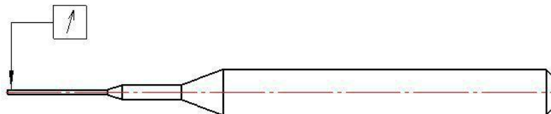
图 18 径向跳动检验方法
